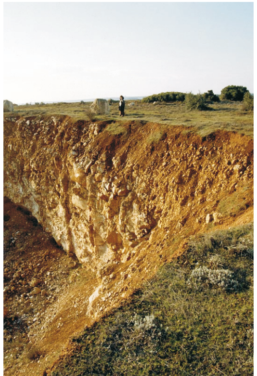
Foto 4.- Afloramiento de la caliza de los páramos en una cantera en los Santos de la Humosa.
