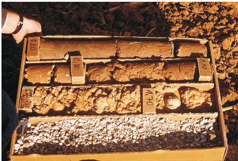
Foto 2.- Testigos de un sondeo realizado en las proximidades del Campus. Se observan las arcillas de la Unidad inferior del Mioceno.
